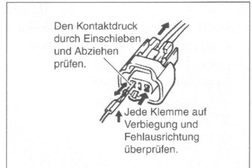
Bei unzureichendem Kontaktdruck umbilden, um den Kontaktdruck zu erhöhen, oder auswechseln.
