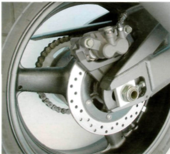
Erről szól a fékezés: elöl kettős tárcsafék, míg hátul mim'máltárcsa és „törpe” féknyereg. Hatásukban is pontosan ekkora a különbség: nem több, de nem is kevesebb!
